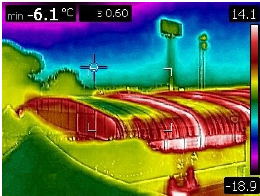
Imagen 9: Pérdidas energéticas a través de cerramientos.
