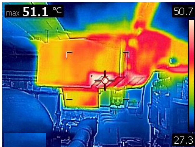
Imagen 8: Pérdidas energéticas en conducciones de aire.
